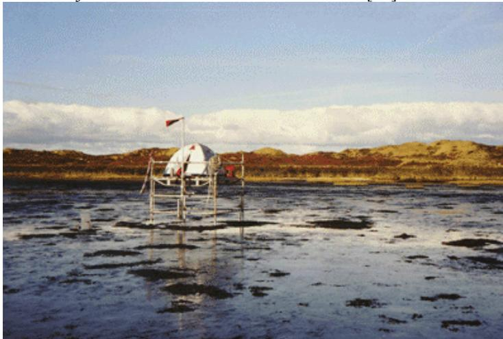
Abb. 1. Provisorische Messplattform des AB Wasserbau der TUHH im Sylter Watt
