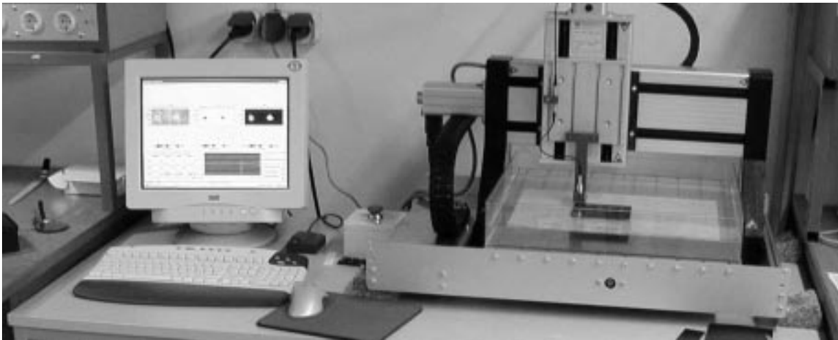
Abb. 1 Ultraschall-Prüfsystem mit Manipulator
