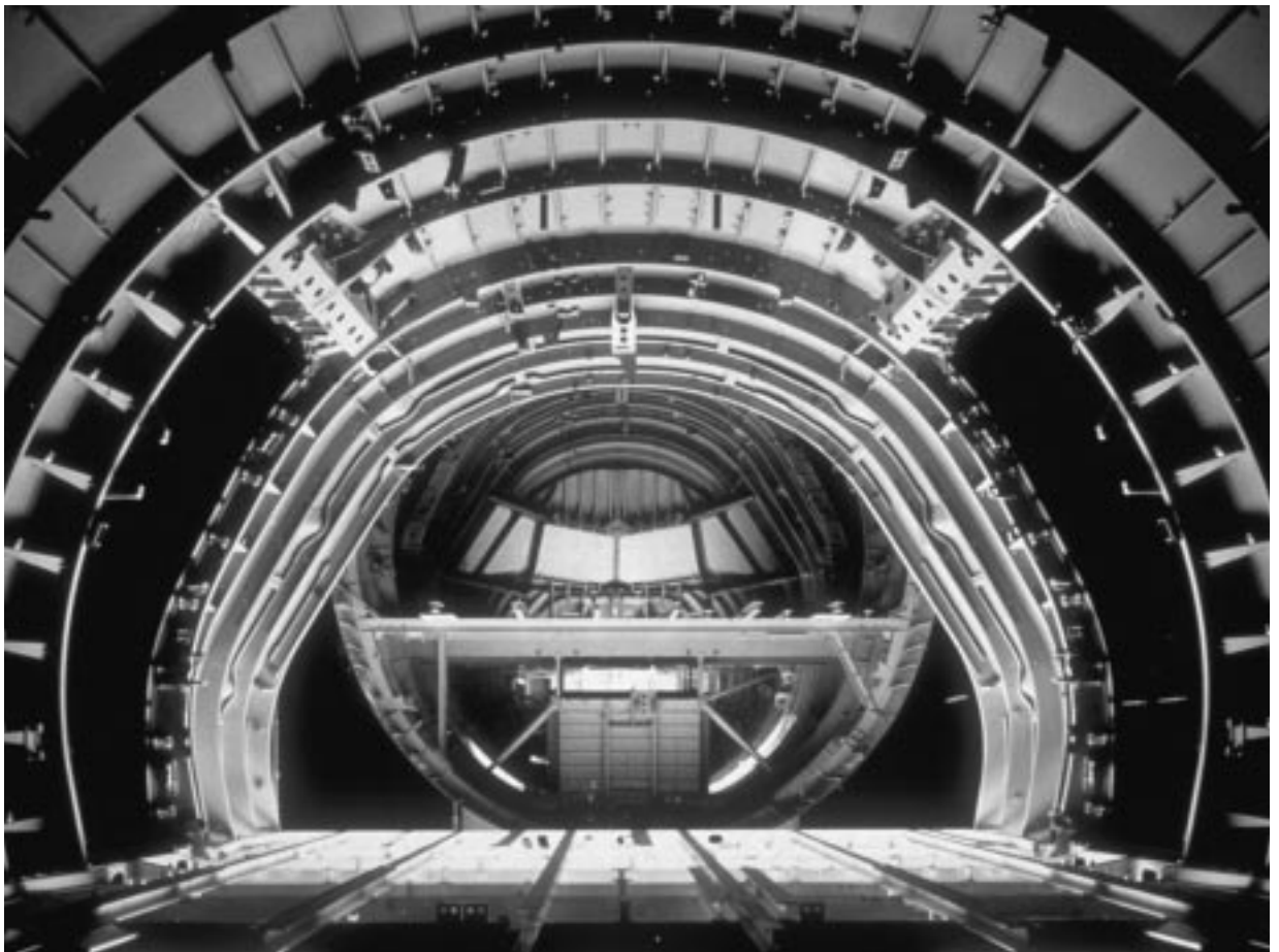
Abb. 1 Flugzeugrumpf in der Strukturmontage
