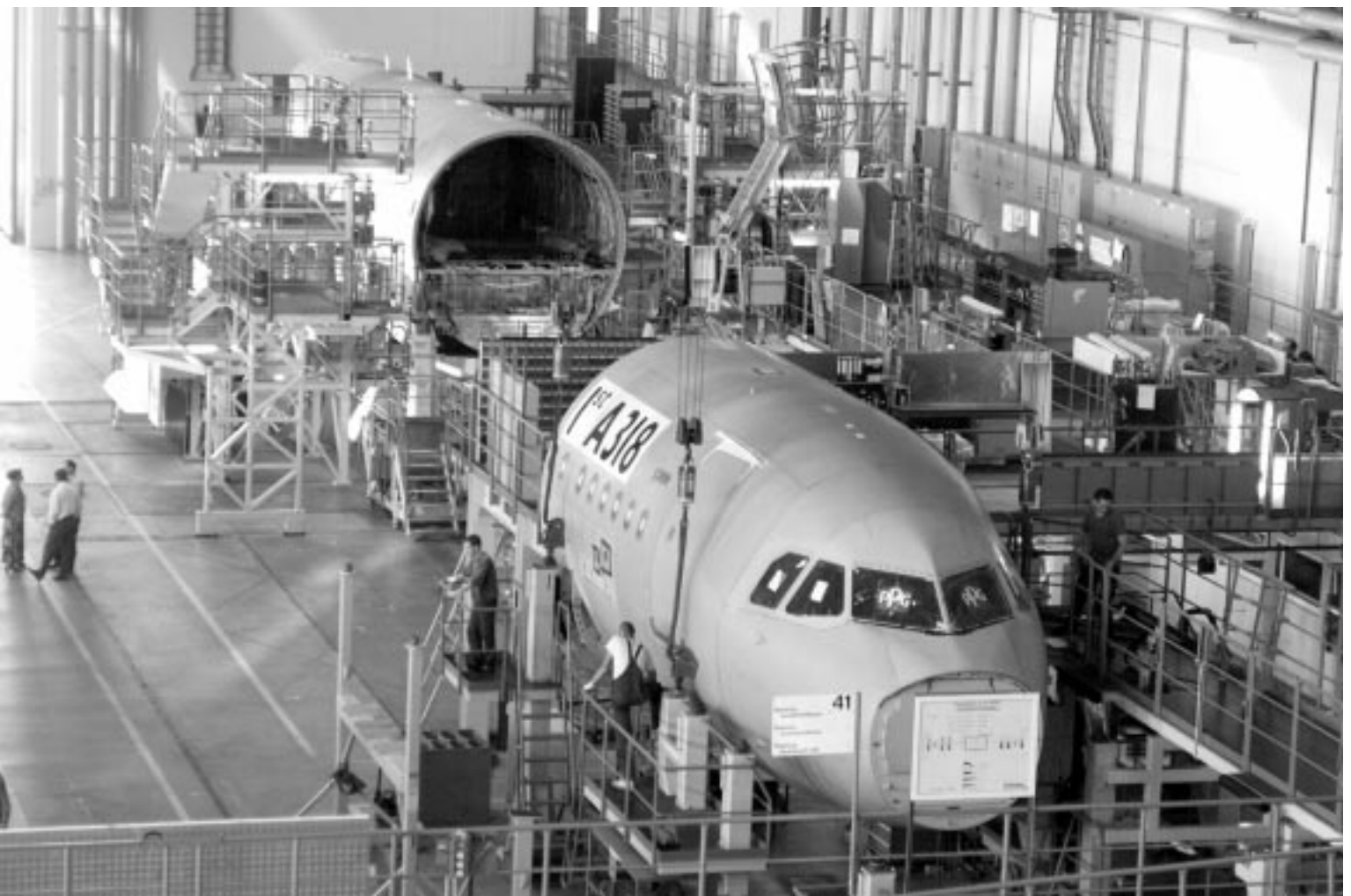
Abb.1 oben und rechts Bauplatz 41 in der Endmontage Das in Hamburg gefertigte Rumpfteil wird mit der in Frankreich gebauten Cockpitsektion zusammengefügt.
