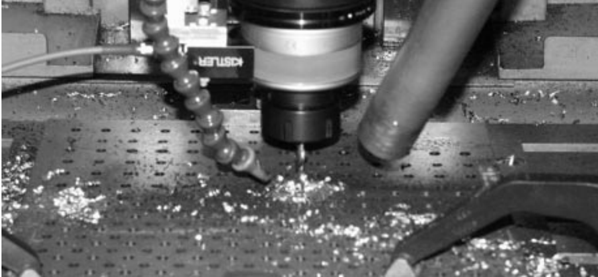
Abb.2 Rotierendes Schnitt- kraftdynamometer zur werkzeugseitigen Messung von Schnitt- moment und Vorschubkraft bei der maschinellen Bearbei- tung eines Schichtver- bundes aus CFK/Titan/ Aluminium
