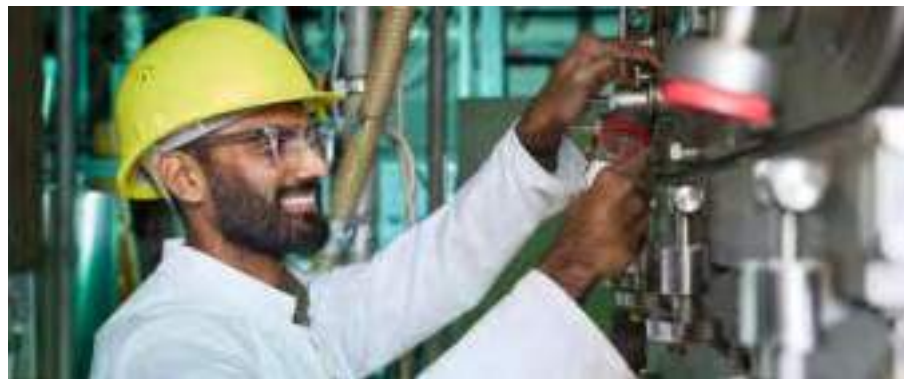
Asif Shaik entnimmt während eines aktiven Granulationslaufs Proben von schichtgranulierten Natriumbenzoat-Partikeln aus einem Wirbelschichtreaktor, um die Produktqualität zu bewerten
