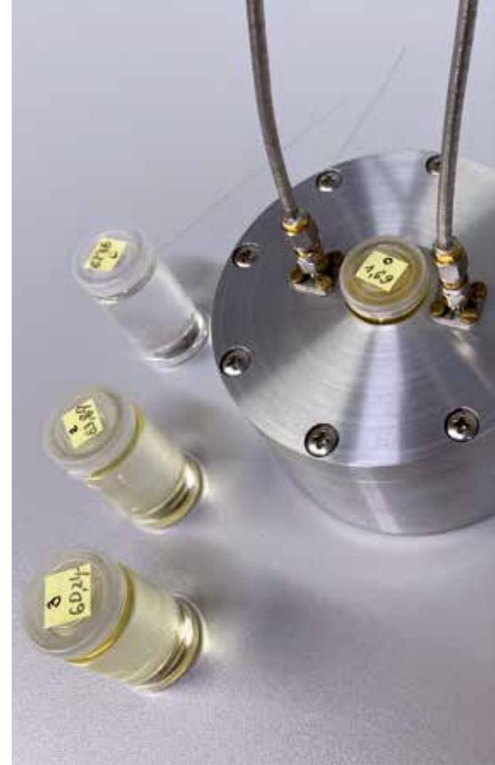
Das Gerät misst den Anteil des Wasserstoffs in der Flüssigkeit
