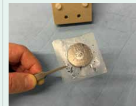
Der erste Prototyp hat zwei beschichtete leitfähige Platten, zwischen denen Wasser als Elektrolyt dient
