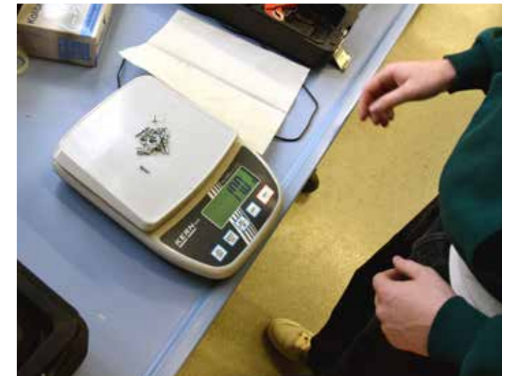
Die Bestandteile der Kaffeemaschine werden nach Materialgruppe einzeln gewogen
