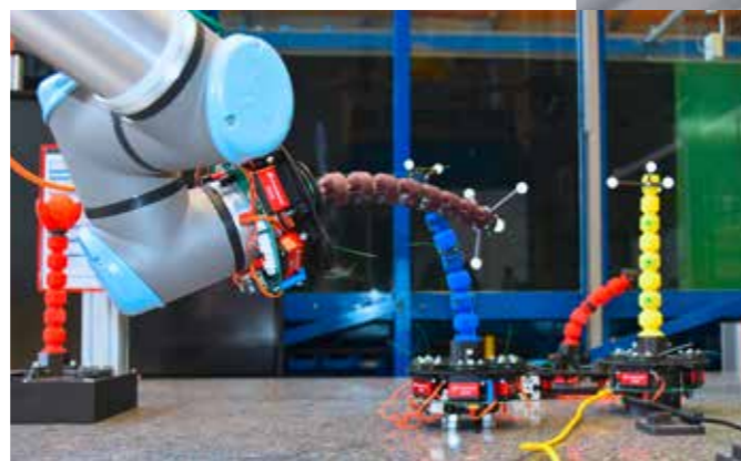
Softroboter bestehen aus nachgiebigen Materialien, die sich biegen, drehen und berühren können
