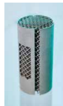
Einige der adaptive Materialien werden per 3-D-Druck gefertigt
