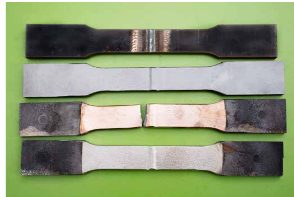
An sogenannten „Dogbone Samples“, knochenförmigen Probestücken, wird die Spannungsbelastung getestet
