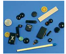
Verschiedene HF- und UHF-RFID-Transponder im Größenvergleich zu einem Streichholz.
