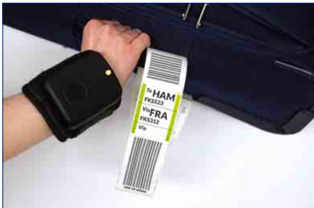
Abbildung 1: Automatisierte berührungslose Datenerfassung während des Greifvorganges bei einem mit RFID ausgestatteten Gepäckstück.
