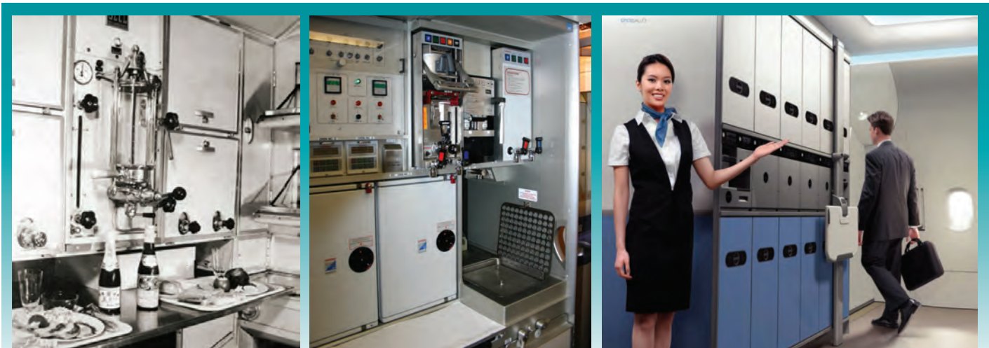
Bild 2: Links: Historische Bordküche der Firma Sell aus den 50er Jahren. Mitte: Der seit 1969 bis heute etablierte ATLAS-Standard. Rechts: Das im Jahr 2010 vorgestellte SPICE-Konzept des Flugzeugherstellers Airbus. Fotos: Sell GmbH (links), Airbus Operations (Mitte u. rechts)
