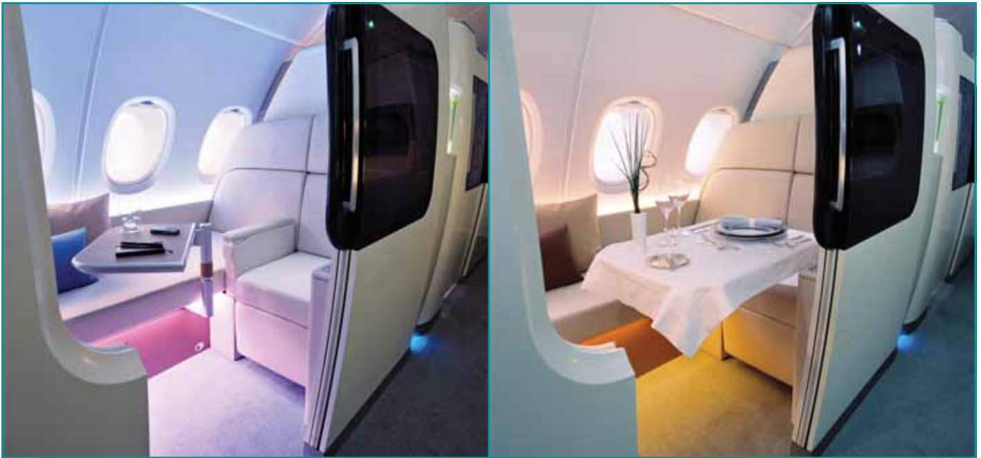
Bild 2: Unterschiedliche Farbtemperaturen und Lichtfarben wirken auf die Umstellung unserer „inneren Uhr“. Moderne Beleuchtungstechnik kann hierbei unterstützen. Fotos: Airbus S.A.S.
